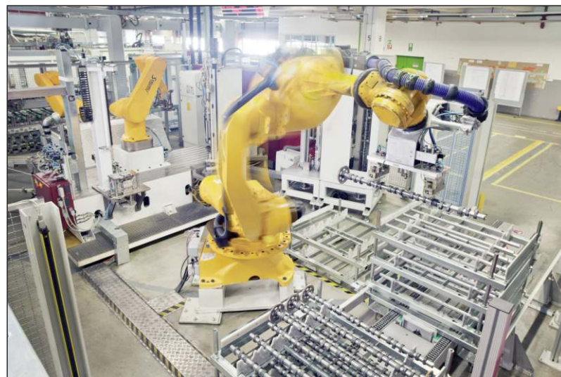
Vačkové hřídele jsou do hlav vsazovány robotem
