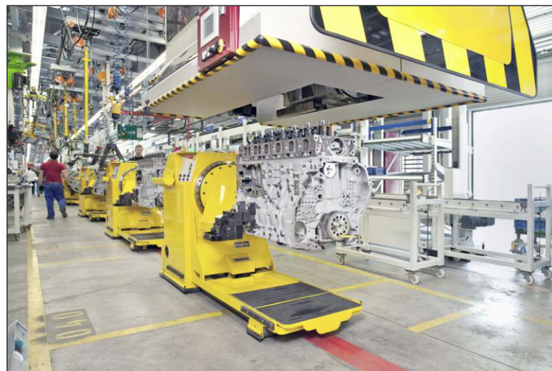
Výrobní linka v Mannheimu – automat na utahování hlavy
