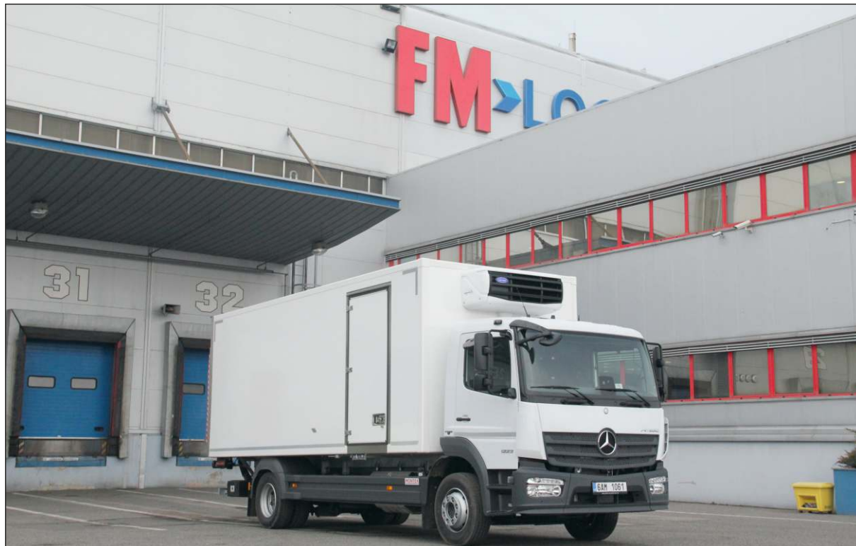
Atego 1223L v běžném rozvázkovém provedení s chladiřenskou nástavbou
