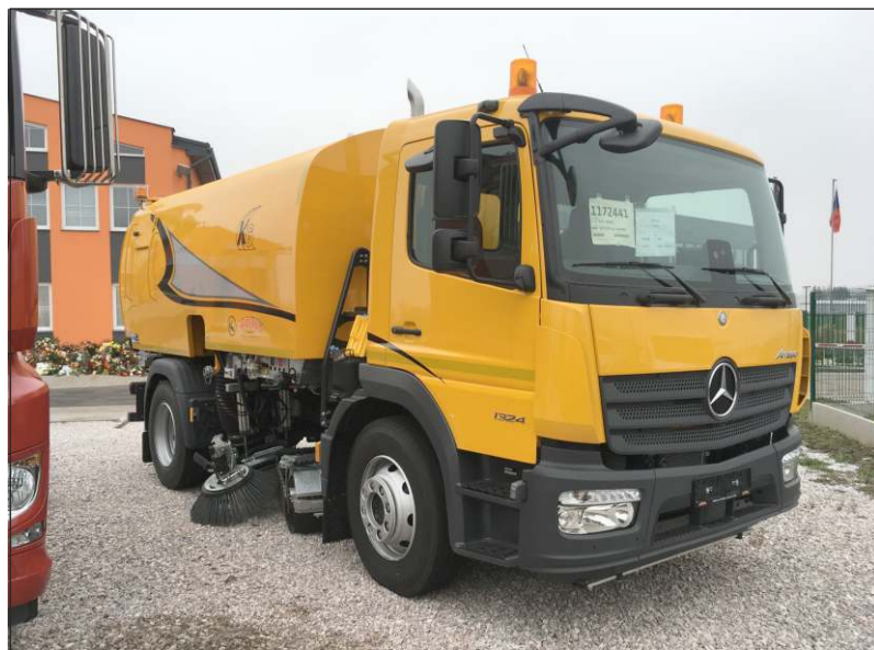
Atego 1324KO, současné provedení, se zametací nástavbou české firmy Kobit
